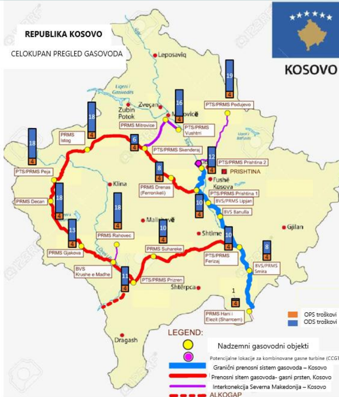
SLIKA 3 – KOSOVSKI SISTEM ZA TRANSPORT GASA SCENARIO GASIFIKACIJE VEĆEG OBIMA SA PROSEČNIM TARIFAMA
