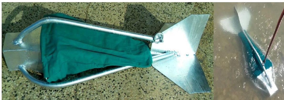
Slika 7: Batometar za proučavanje uzorka vučenih sedimenata
