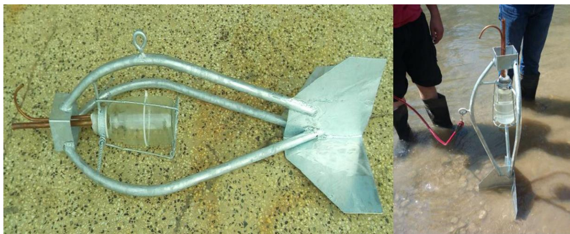
Slika 6: Batometar za pregled uzoraka suspendovanih sedimenta
