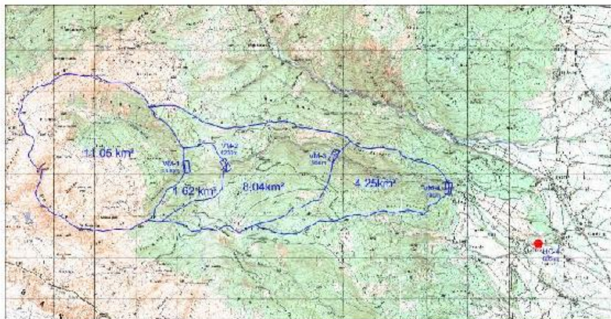
PELLGU UJËMBLEDHËS I LUMBARDHËS SË LLOÇANIT DHE PELLGJET PËRKATËS TË HEC-ve SIPAS SKEMËS SË SHFRYTËZIMIT HIDROENERGJETIK Shkalla 1 : 25 000
